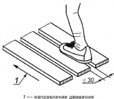
Рисунок 13 — Измерение щелей размером не более 30 мм
